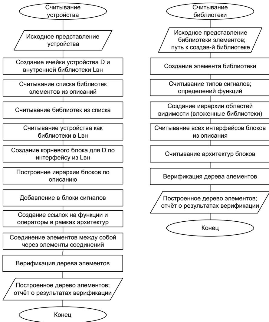
Рис. 3.5. Рекомендуемый порядок считывания представления устройств и библиотек из внешнего структурного описания
